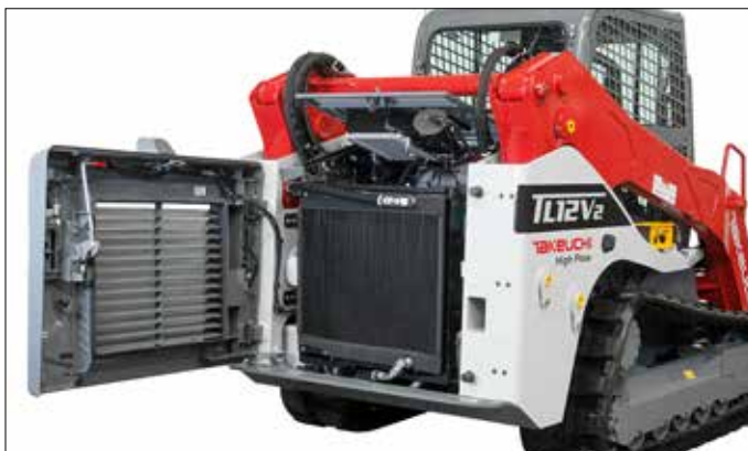
Závěsná zadní část zaručuje optimální přístup pro čištění a údržbu chladiče na vznětovém motoru.
