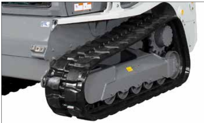
Dvě planetové převodovky zajišťují optimální pojezdovou rychlost a poskytují dostatek síly pro práci s těžkým pracovním příslušenstvím.
