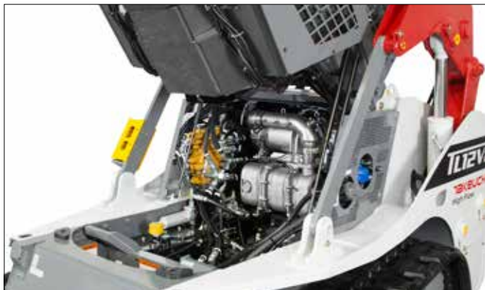
Sklopná kabina umožňuje snadný přístup k motoru a k hlavním hydraulickým komponentům.
