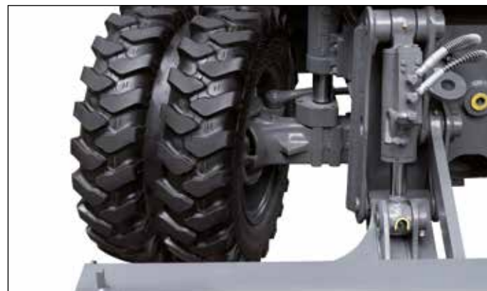
Kvalita: nápravy od Dana Spicer. Řízená náprava jako kyvná náprava, s automatickou oscilací.
