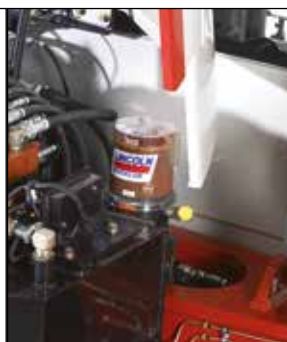
Centrální mazací systém s upozorněním při vyprázdnění maziva
