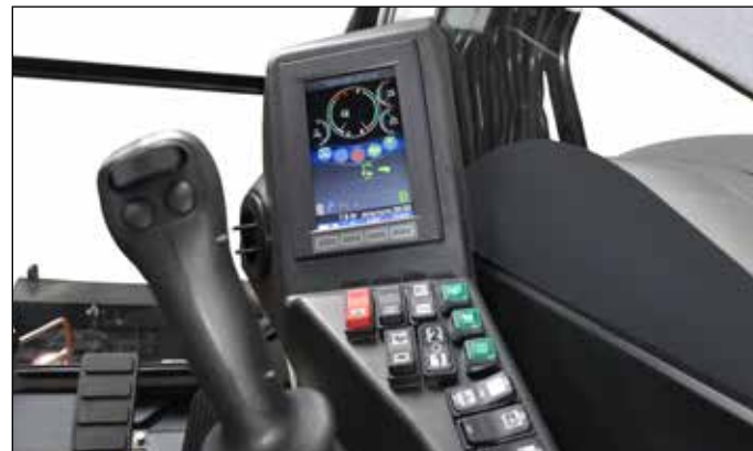
Přehledný displej přístrojové desky se zvukovými i vizuálními výstrahami. Ve výchozím nastavení s režimem ECO.
