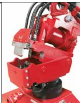
Systém Huppi-Quick: hydraulické okruhy jsou automaticky spojeny rychlospojkami
