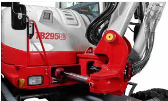
Robustní otočný kožlák se speciálně ochrannými hadicemi i hydraulickým posuvem.
