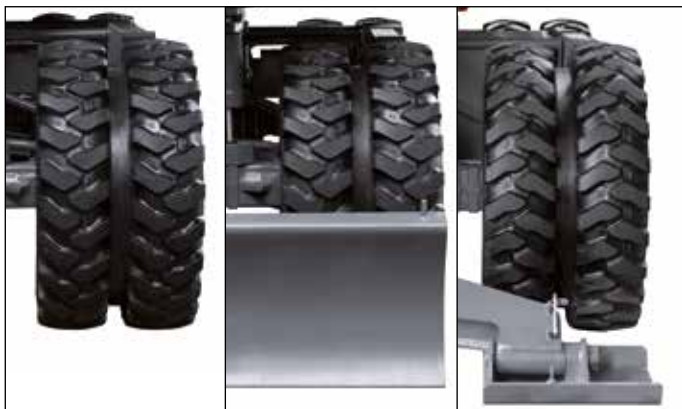
Stabilizační patky (volitelné) pro ideální stabilitu, vyjímatelné a nahraditelné dalšími radlicí.
