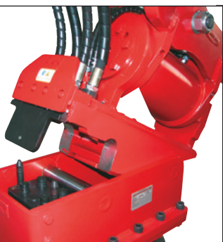
Systém Huppi-Quick: hydraulické okruhy se automaticky spojí rychlospojkami
