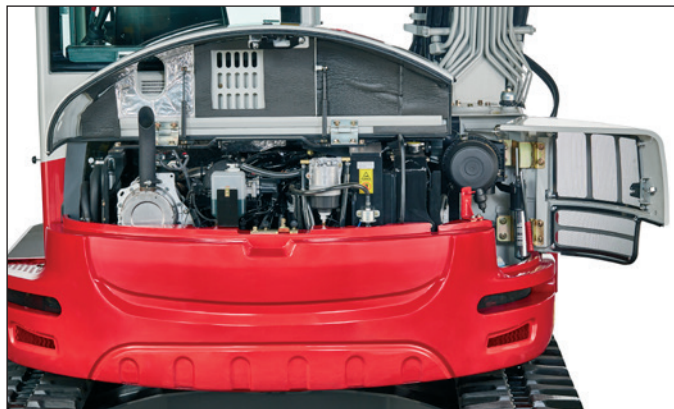
Generace tichých motorů s redukováním množství výfukových plynů, velký motorový prostor, výfuk směrem vzhůru, masivní protizávaží.
