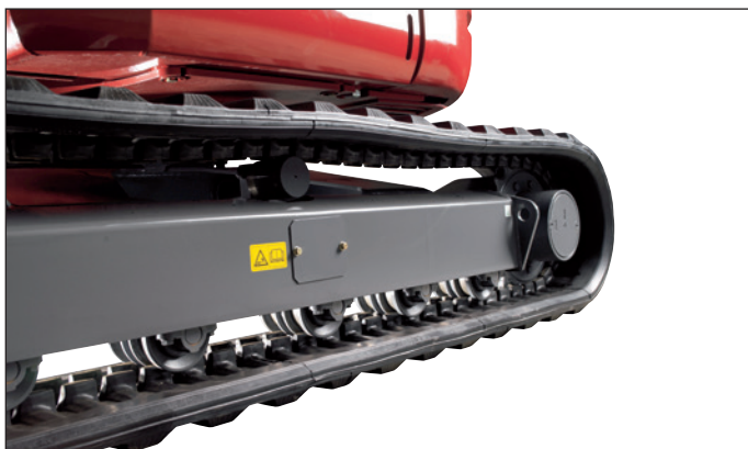
Rolny s vnitřním i vnějším vedením zamezují vyuzutí gumového pásu, gumové pásy s krátkou roztečí minimalizují vibrace při jízdě.
