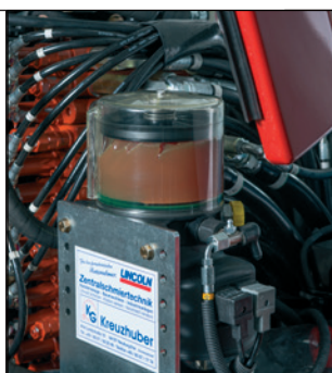
Centrální mazací systém s upozorněním při vyprázdnění maziva
