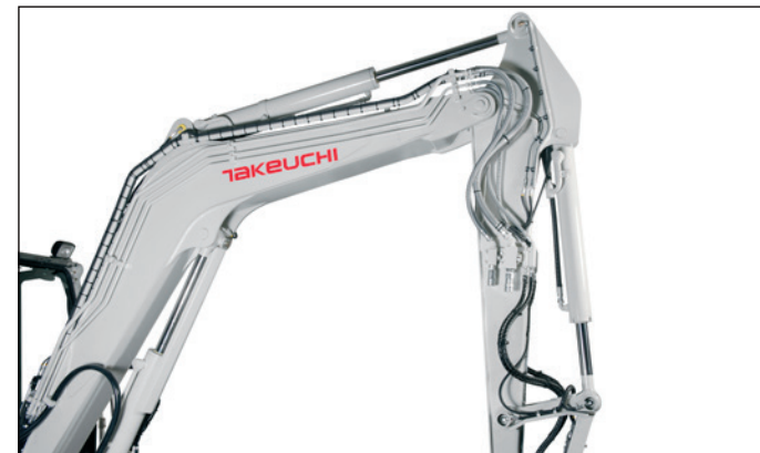
4 přídavné hydraulické okruhy, z toho 3 ovládané proporcionálně, průtoky regulovatelné na displeji.
