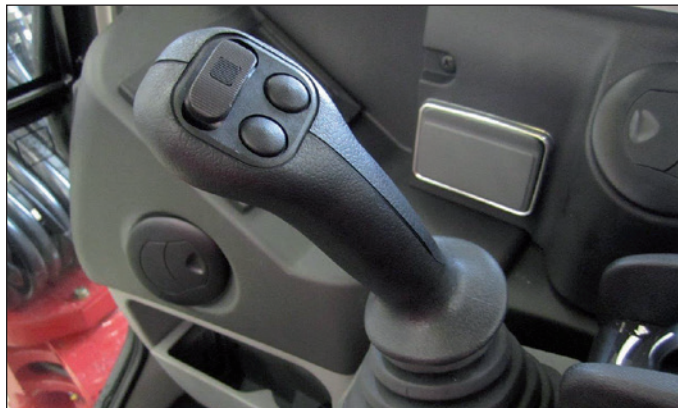
Proporcionální ovládání přídavných okruhů na levém i pravém joysticku.
