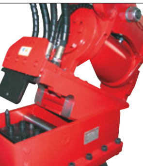
Systém Huppi-Quick: hydraulické okruhy jsou automaticky spojeny rychlospojkami
