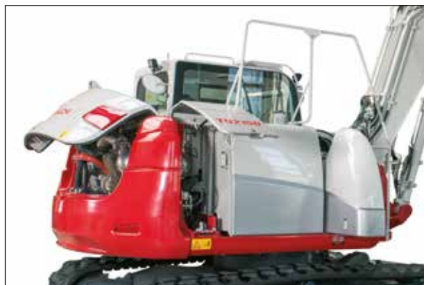
Masivní zadní protizávaží a ocelové kryty dávají stroji robustní pouzdro, a to navzdory zachování nejlepšího možného servisního přístupu.
