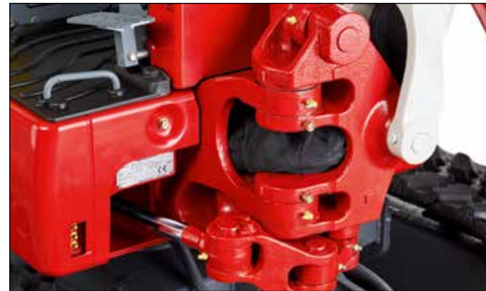
Robustní otočný kozlík. Hydraulický válec výložníku s tlumením koncové polohy.
