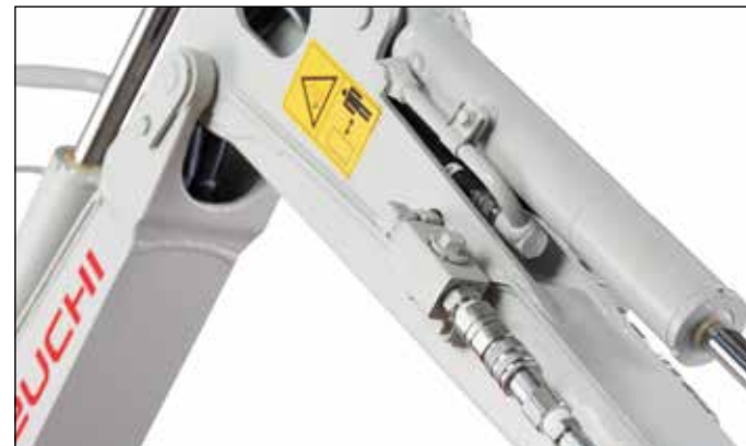
1 přidavný hydraulický okruh, ovládaný pomocí nožního pedálu.
